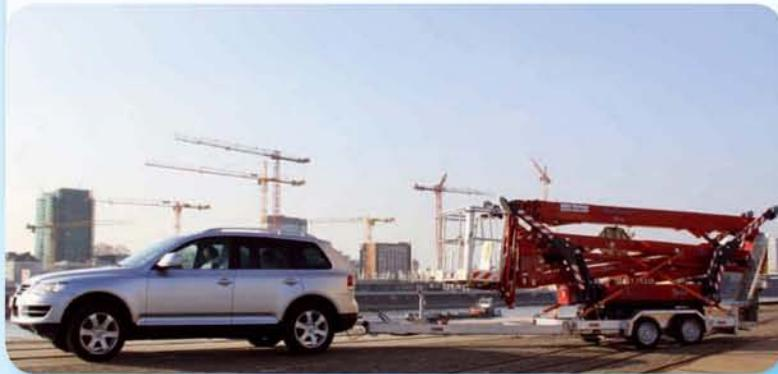
Questa nuova piattaforma Hinowa è un concentrato di performances e tecnologie ad altissimo livello. Il peso di soli 3000 kg (versione benzina) è una delle caratteristiche che la rendono unica. Una piattaforma che può raggiungere una altezza operativa di 23 metri, uno sbraccio orizzontale di 12 metri e che può essere trasportata sui trailer appendice, ad oggi non esisteva. L'area operativa verticale è mantenuta fino a 12 metri di altezza senza dover correggere lo sfilo.
